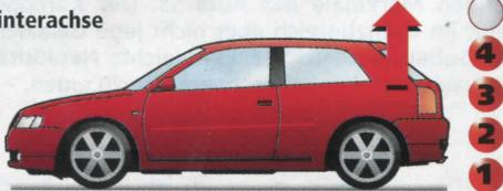
Der  $c_w$ -Wert des Viertürers ist wegen der zerklüfteten Front und den vielen Kühlluftöffnungen nicht gut entwickelt: 0,35. Das kostet Tempo – siehe Döttinger Höhe – und einen nicht unerheblichen Spritzschlag. Der auffällige Heckflügel zeigt gute Wirkung. Der Auftrieb an der Hinterachse ist mit
