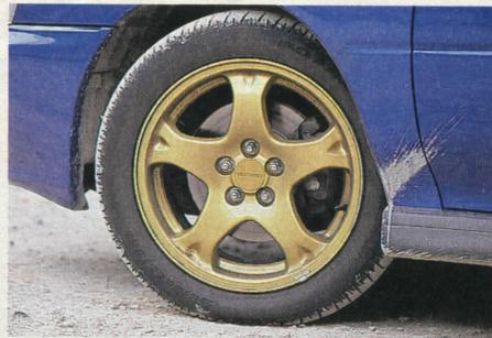
Rallye-WM-Gold auf den 7 × 16 Zoll-Felgen. Die vorderen Bremsen wurden für den neuen Modelljahrgang verbessert. Der weit vorne eingebaute Vierzylinder-Boxer sorgt für Kopflastigkeit im Fahrverhalten
