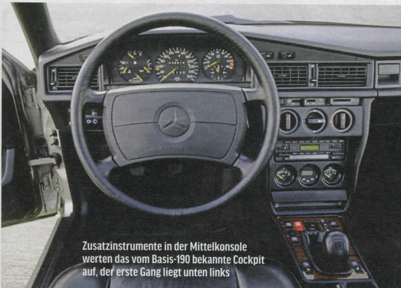
Zusatzinstrumente in der Mittelkonsole werten das vom Basis-190 bekannte Cockpit auf, der erste Gang liegt unten links
