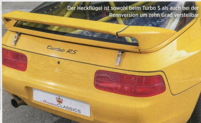
Der Heckflügel ist sowohl beim Turbo S als auch bei der Rennversion um zehn Grad verstellbar
