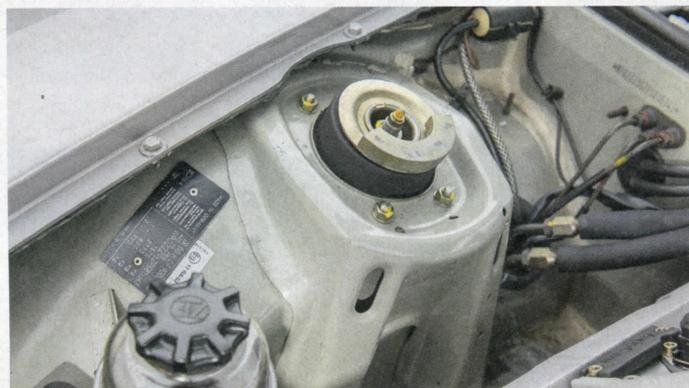
Bei offener Motorhaube sieht man die verschärften Testbedingungen: Hier die Karosserie nur von der Zinkschicht geschützt
