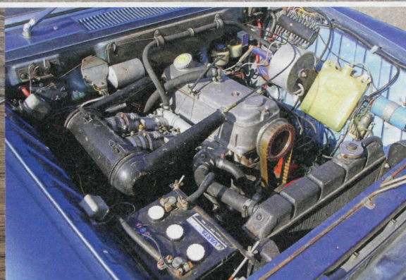
Der Motor des 1700 TS ist ein Langhuber und leistet 100 PS. Er war einer der ersten Motoren mit Zahnriemengetriebener Nockenwelle
