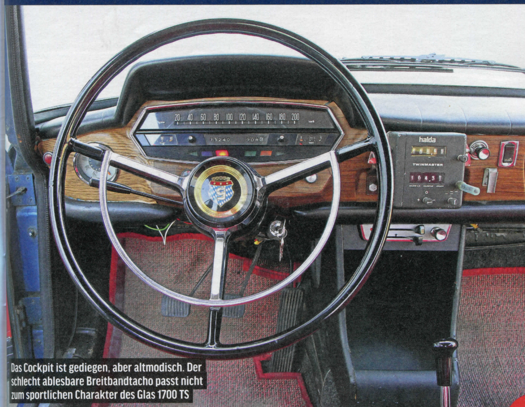
Der Drehzahlmesser ist zu klein, liegt nicht im Fahrer-Blickfeld und dient mehr zur Zierde statt Information
