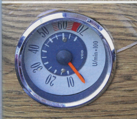
Der Drehzahlmesser ist zu klein, liegt nicht im Fahrer-Blickfeld und dient mehr zur Zierde statt Information
