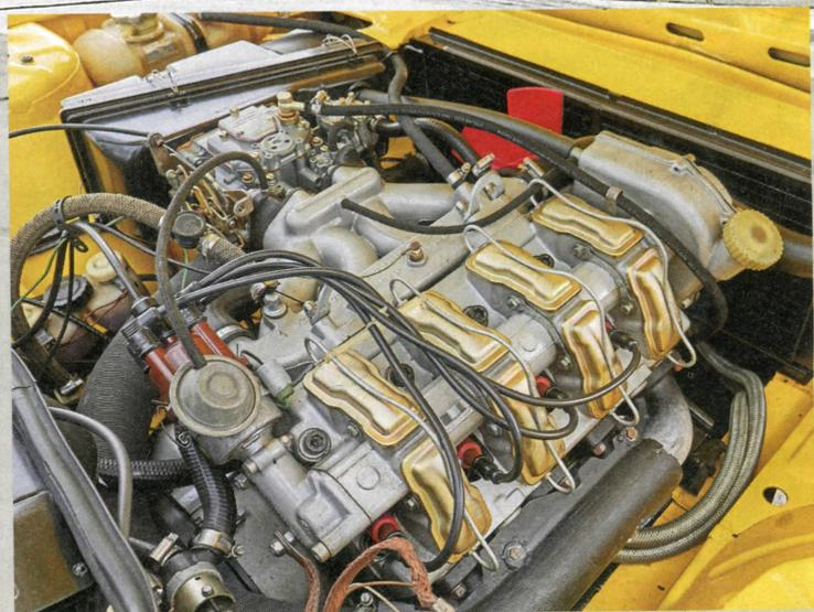
Wie aus dem Laden: 1,8-Liter-Vierzylinder in leichter Schräglage. Gut zu erkennen: die Deckelchen, unter denen die Kipphebel des Ventiltriebs ihren Steptanz aufführen
