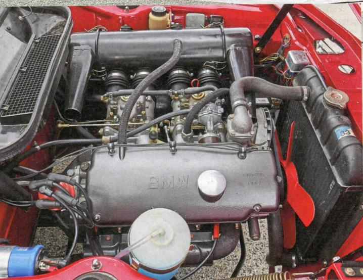
Keine matching numbers, aber so was von amtlich: der Originalmotor vom 1800 TI/SA mit zwei Weber Doppelvergasern vom Typ 45 DCOE. Wir haben keine Einwände
