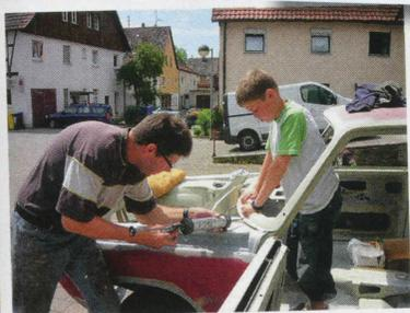
Die Schweißnähte schützte Rainer Voget mit Dichtmasse aus der Kartusche.
