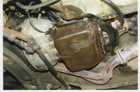
**Automaten (Bild) sind unbeliebt, bei Getrieben bis 1968 verschleißt die Porsche-Synchronisierung**
