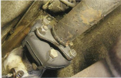
Sowohl die Kardanwellen als auch die Hinterachs-Verteilergetriebe geben kaum...
