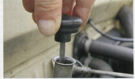
**Automatikgetriebe:** Neben einem Fahrtst sollte der Ölstand gecheckt werden
