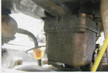
**Vergaser:** Bei den Solex schlagen die Wellen der Drosselklappen mit der Zeit aus
