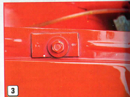
3 DIE SCHRAUBKANTEN der Kotflügel halten der braunen Pest kaum stand, rostfrei sind sie selten
