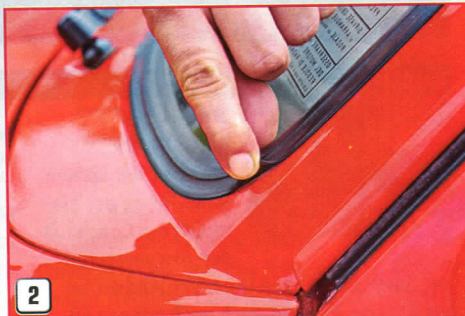
2 DIE ECKEN des Windschutzscheibenrahmens halten der Feuchtigkeit nicht lange Stand und rosten gerne
