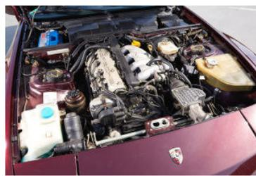
Zwei oben liegende Nockenwellen, drei Liter Hubraum, vier Zylinder, 16 Ventile und 211 PS. Der S2-Motor war der hubraumstärkste Vierzylinder seiner Zeit.
