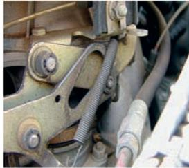
Gasgestänge: Sind Federn und Bolzen vollständig?
