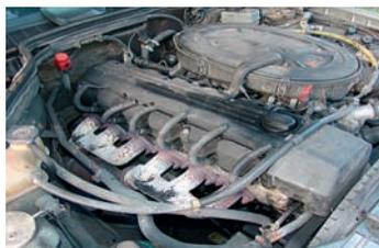
**Kopfdichtung:** Die Ölquelle bildet sich immer am hinteren Ende, zur Spritzwand hin
