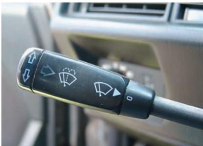
**Lenkstockhebel: Er verschmort, wenn das Scheibenwischergestänge schwergängig ist**
