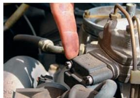
...defekte Drucksteller am Mengenteiler...
