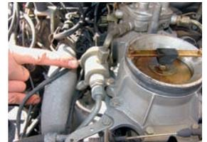
...KE-Jetronic. Fehlerquellen hier: der Benzindruckregler...
