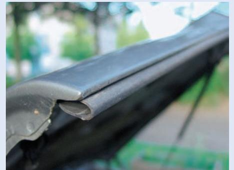
**Nicht üblich, aber möglich:** Kofferraum- und Motorhaube können Kantenrost ansetzen
