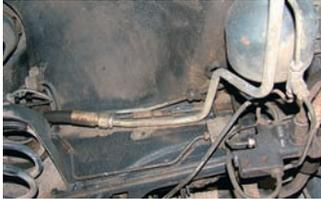
**Achillesferse:** hydropneumatisches Fahrwerk mit Federspeichern
