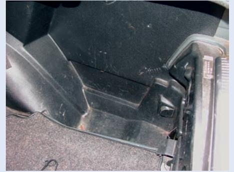
**Kofferraum:** Bei undichter Heckscheibe sammelt sich in den Seitentaschen und...
