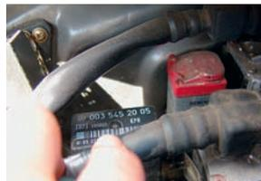
Versteckt: das Benzinpumpen- und KE-Schutz-Relais
