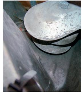
Motorlager: Mit dem Öl geht die Dämpfung verloren
