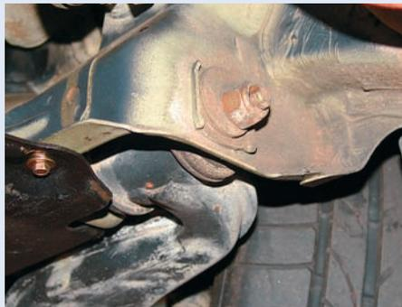
**Die vorderen Querlenkeraufnahmen:** An ihnen nagt bisweilen die Korrosion
