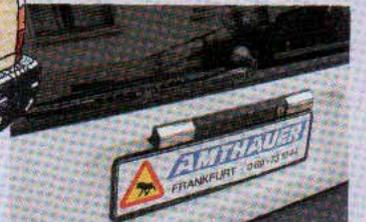
Dauerhaft rostfrei: Auch die Heckklappe ist aus Aluminium
