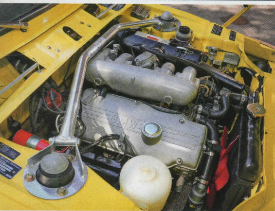
Drei Rundinstrumente, Recaro-Sportsitze und ein 130 PS starker Zweiliter mit Kugelfischer-Einspritzanlage. Bei der Domstrebe handelt es sich allerdings um kein Originalteil
