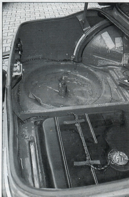
Öffnen Sie den Deckel! Reserveradwanne, Scharniere und Stoßdämpferaufnahme rosten.
