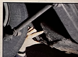
Radlauf vorn: Hier hat sich der Rost eingenistet, Abhilfe schafft nur der Schweißbrenner
