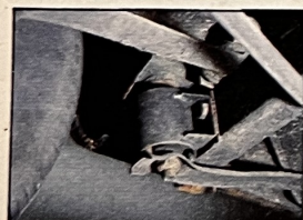
Hinterachse: Trotz gutem Unterbodenschutz rostet es bereits an der Aufhängung
