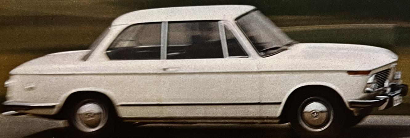
einem Fünfganggetriebe ausgerüstete Testauto erreichte 190 km/h und war bereits in 9,7 s von 0 auf 100 km/h. Gemessen an diesen ausgezeichneten Werten, die sich ansonsten nur mit wirklichen Sportwagen oder Limousinen größeren Kalibers reproduzieren lassen, nehmen sich die Fahrleistungsziffern des Basismodells mit 1,6 Liter Hubraum
