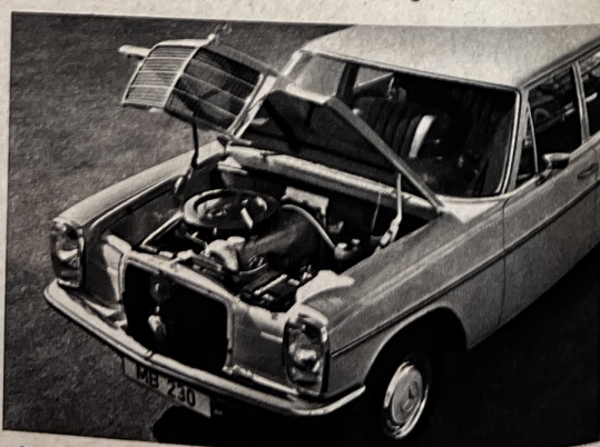
Im verkürzten Motorraum ist noch genügend Platz für einen Sechszylinder: Hier der des 230.
