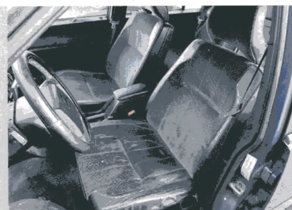
Lordosenstützen und Sitzheizungen fallen öfter aus. Erstere lassen sich gut reparieren, Letztere nur mit größerem Aufwand
