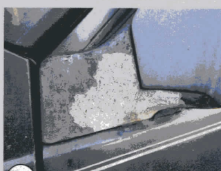
3 Bei Autos ohne trockenen Stellplatz korrodieren des Öfftens die Ausleger der Außenspiegel
